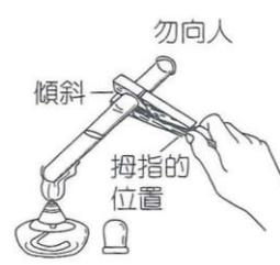
圖：試管的加熱
